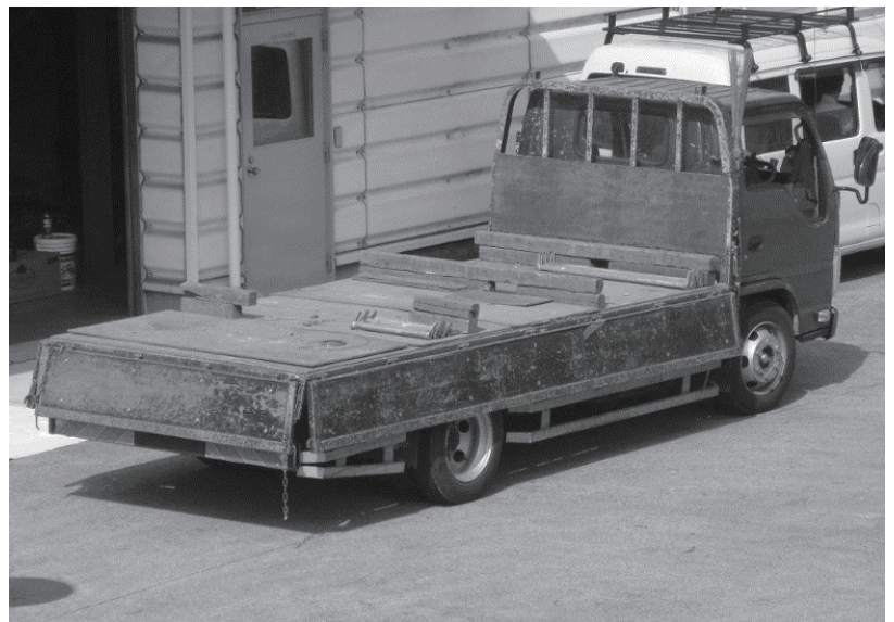
■ 図1 / 作業者の昇降設備がない荷台例 (左:ウイング車、右:平ボディ車)
