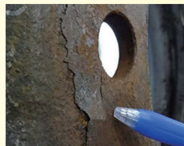
ディスク・ホイールの表面やホイール・ボルト穴の周辺は、著しいさびによる損傷や剥離が進んでいた
