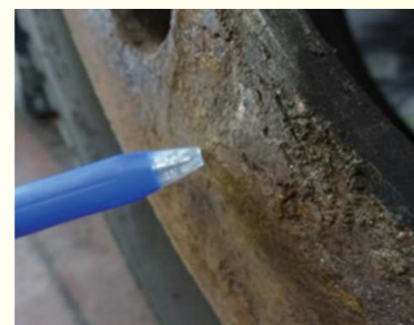
ディスク・ホイールの表面やホイール・ボルト穴の周辺は、著しいさびによる損傷や剥離が進んでいた
