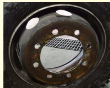
ディスク・ホイールの表面には著しいさびが発生
